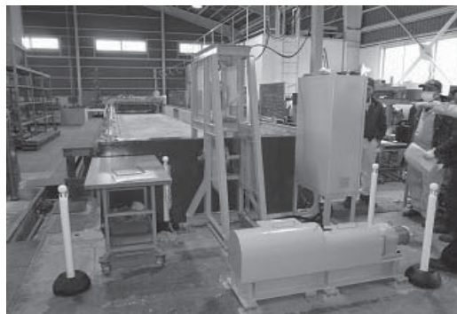
4-2 荒天航泊訓練装置 (碇把駐力実験装置)
