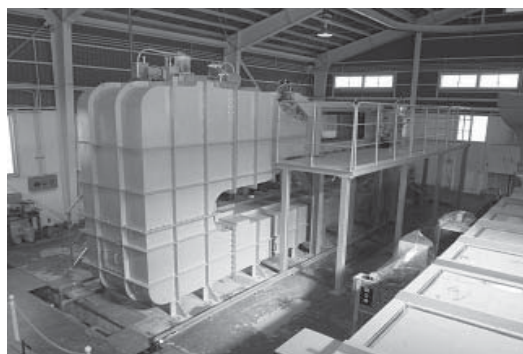
4-1 荒天航泊訓練装置 (回流水槽)
