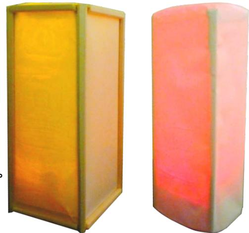
趣旨・目的 照度センサとLEDを用いた、まわりが暗くなると明かりをともす「夜光灯」を製作します。外装にペットボトルと割り箸を利用することで、灯籠らしさを出すと共にリユースの概念について考えます。(はさみや小さな電子部品を使用するため、低学年は保護者同伴でお願いします。)
