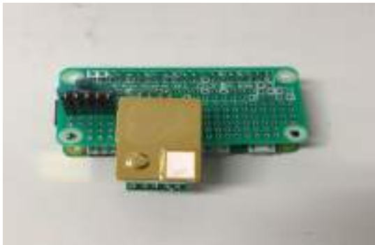
図11 raspberry pi zero WHを使用した測定器
