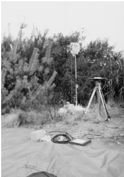
写真2 陸上側ユニットの設置状況
