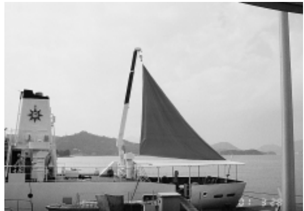
写真4 デッキクレーンによる三角帆の展帆状況
