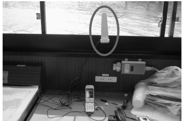
写真2 船に設置した補助アンテナ
