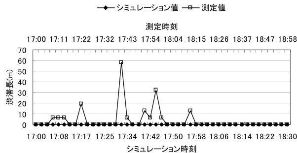
図16 広島市役所前信号交差点の東行き流入路における右折車線の渋滞長の測定値とシミュレーション値の比較
