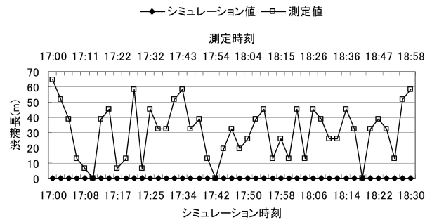
図18 広島市役所前信号交差点の北行き流入路における直左折車線の渋滞長の測定値とシミュレーション値の比較
