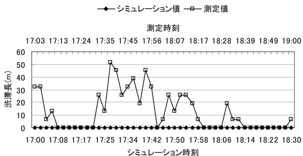
図17 広島市役所前信号交差点の南行き流入路における右折車線の渋滞長の測定値とシミュレーション値の比較
