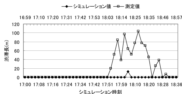
図25 国泰寺信号交差点の西行き流入路における直左車線の渋滞長の測定値とシミュレーション値の比較
