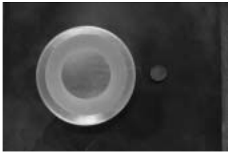
Fig.4 銀銅合金ラップおよびガラス試料
