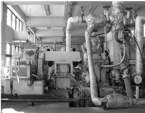
図1 本校蒸気タービン
