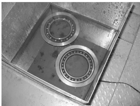
図13 油で過熱しているベアリングの様子
