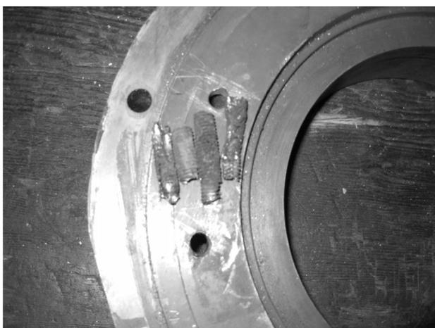
図10 外側フレームと折れたねじ
