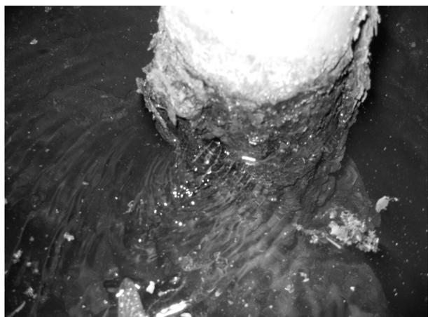
Fig.21 腐食して破損した管
