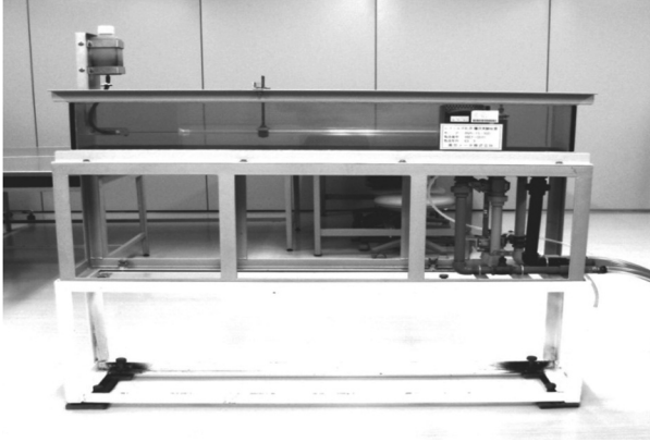
Fig.1 レイノルズ乱層流実験装置
