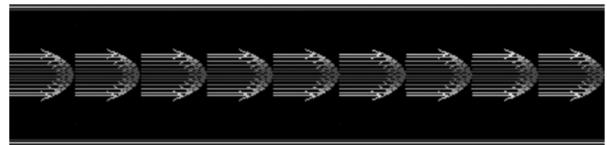
Fig.23 層流の速度分布 (拡大)
