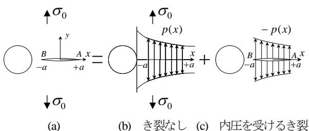
図2 切欠き近傍にき裂をもつ無限板
