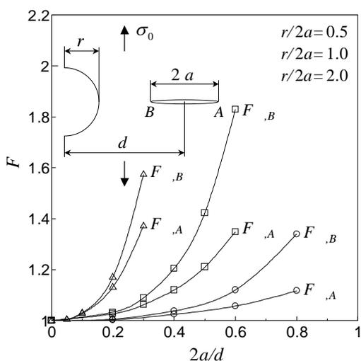
図 12 片側半円切欠き近傍のき裂の修正係数
