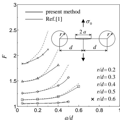
図9 2円孔に挟まれるき裂の修正係数
