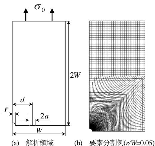
図 13 片側半円切欠き近傍の応力場の解析形状
