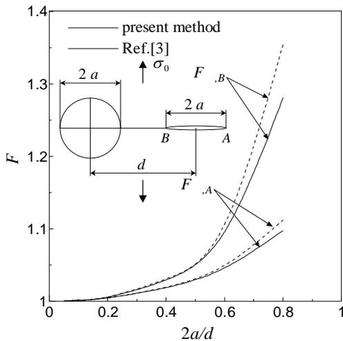
図5 円孔近傍のき裂の修正係数
