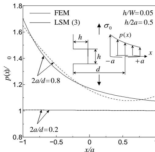
図 14 片側正方形切欠きの応力分布
