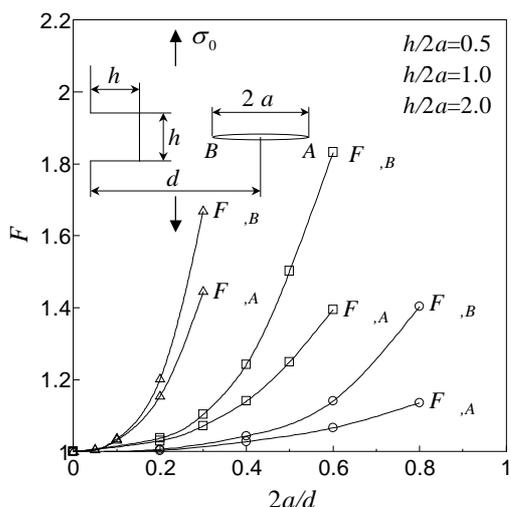
図15 片側正方形切欠き近傍のき裂の修正係数
