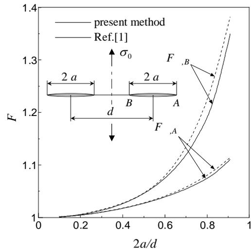
図7 近接する2個のき裂の修正係数
