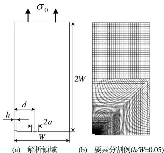
図17 片側正方形切欠きの応力場の解析形状
