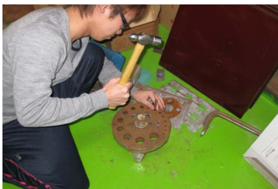
図8 ラバーパッキンに穴を開けている様子
