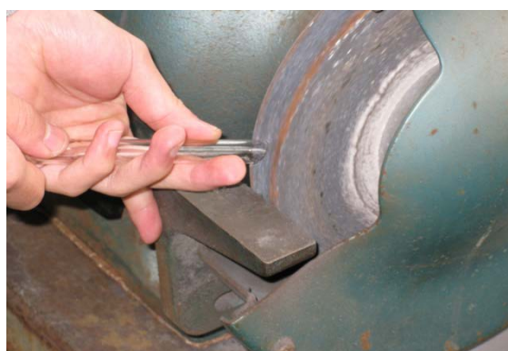
図5 先端を平らに削っている様子
