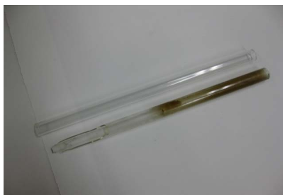
図6 加工済みガラス管と破損したガラス管
