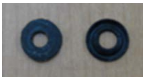
図7 古くなったラバーパッキン
