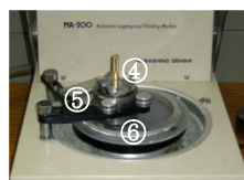
図 1 ラッピング装置 図 2 ラッピング治具 ① 試料 ②試料ホルダー ③ガイドリング ④重り ⑤コロ式試料保持ユニット ⑥ラップ
