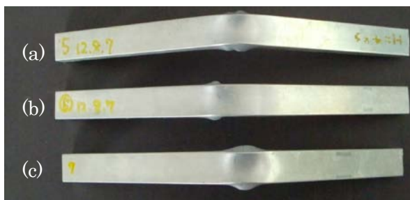
図8 実験後の溝形試験片下側(引張側) (U字)
