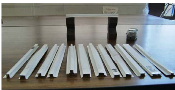
付図4 実験後の試験片 (左側の方が受けもつ負荷荷重が大きい)
