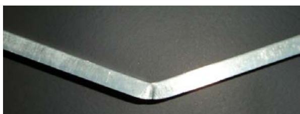
図7 実験後の溝形試験片 (Π字 L=100mm)
