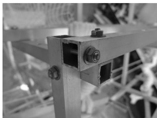
図 2-6 角材の 3 点止め
