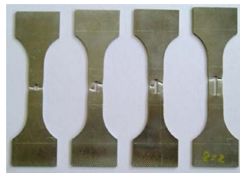
2×2 4×2 6×2 8×2 図7 長方形孔試験片の破断結果(b×a)
