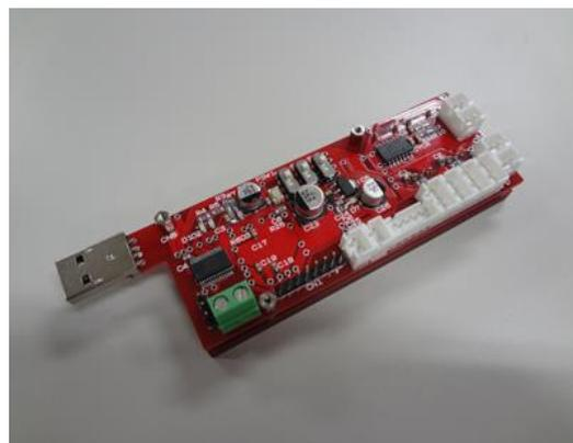
図 4-6 搭載用制御基板(SH7125F)
