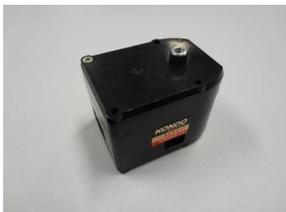
図 3-2 RC サーボモータ (KRS-4034HV ICS)
