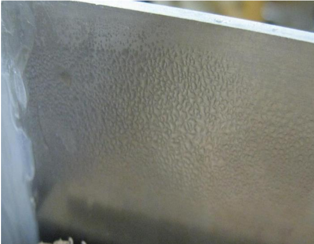
図 7 吸水シート未設置の模型内部
