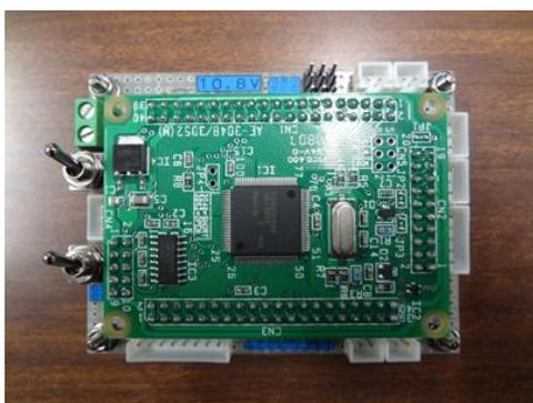
図 4-1 Ver.1.00 用駆動系制御基板
