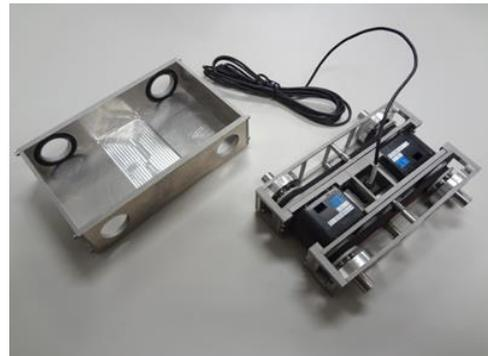
図 3-2 配管検査ロボット Ver.3.00
