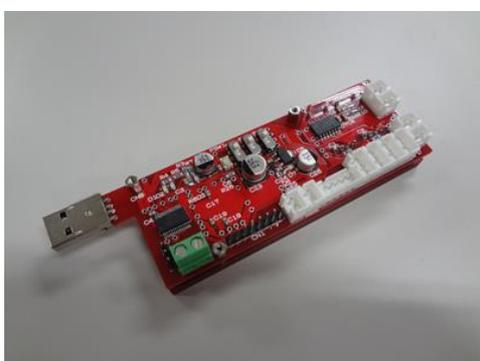
図 4-2 Ver.3.10 用駆動系制御基板
