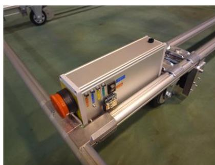
図 2-5 ロボットの制御 BOX
