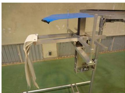
図 2-2 輪の押し上げ機構
