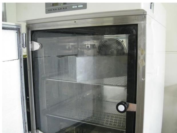
図 6 恒温槽内のコンテナ模型
