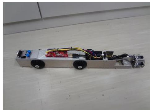
図 3-3 配管検査ロボット Ver.3.10
