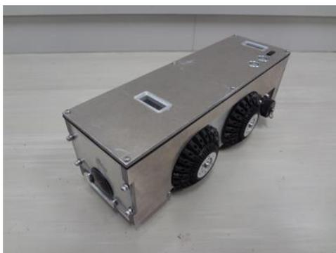
図 3-4 配管検査ロボット Ver.4.00
