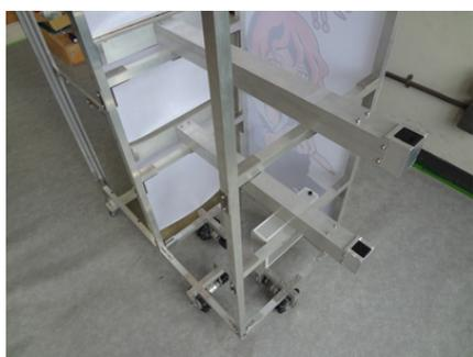
図 6 フレームへの角材使用(Orange-Aika2)
