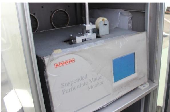
図13 粒子状物質測定装置のモニター
