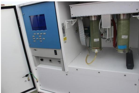
図12 粒子状物質測定装置のシリンダー
