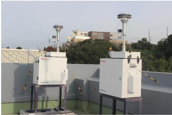
図10 質量濃度測定
