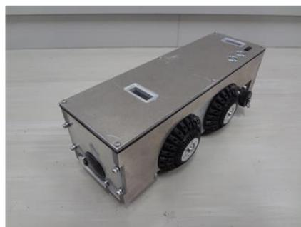
図2-1 小型配管検査ロボット
