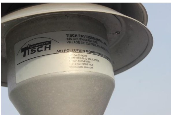
図11 質量濃度測定器のインパクト
