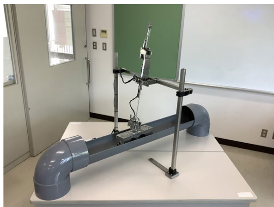
図 1 配管検査用ロボットの位置・姿勢計測
