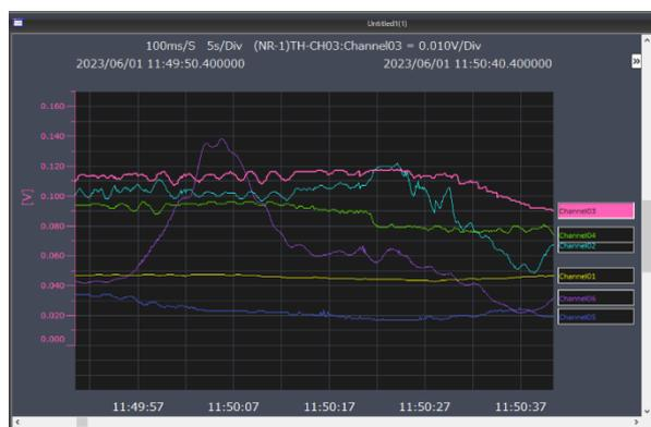
図7 係留索張力測定モニターの一例
