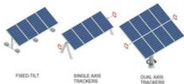
図 24 定置式、単軸および二軸太陽光発電機
