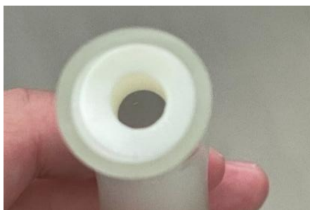
図4 ホースに挿入したインサート
