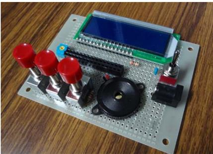
4 年生になるとプログラミング特論、情報工学実験 4 という 2 つの授業を使って、数人の班に分かれ Arduino (アルディーノ) を用いた創造性実験をします。Arduino とは、簡単に電子工作ができる便利な道具で、Wiring 言語という言葉を使ってプログラムを作ります。そうすることで、Arduino を自分の思うとおりに動かすことができます。
