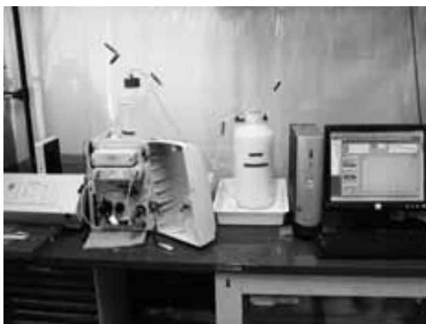
写真1 クリーンブース内に設置されたイオンクロマトグラフィーシステム（右）とオートサンプラー（左）である。写真にはないが、この机の下に廃液タンクが設置されている。この他に、クリーンブース内には蒸留水装置・超純粋装置が設置されており、作業はすべてクリーンブース内で行われる。
