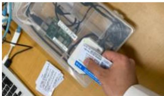
図1 ICカードリーダーによる人員点呼端末
